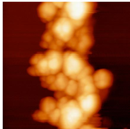
図 白金ナノ粒子を光電着した  $\text{TiO}_2$  表面の原子間力顕微鏡画像。画像サイズ: 500 nm 四方
